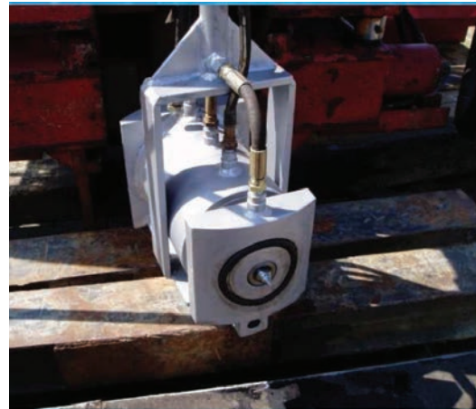
Fig. 17 - Tool per il punzonamento ed iniezione per cementazioni selettive di pozzi esistenti (da IDROGEO).
