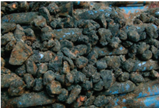
Fig. 4 - Esempio di ageing di un pozzo per acqua, dovuto a incrostazione (Herrmann e Stiegler, 2008).
