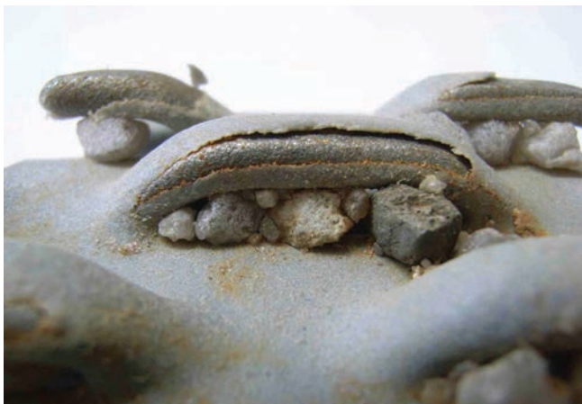
Fig. 2 - Esempio di filtro a ponte + dreni ghiaiosi intasati, dopo sviluppo con pompaggio (Herrmann e Stiegler, 2008).
