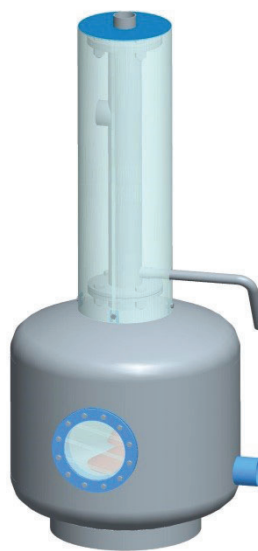
Fig. 13 - Schema "desolfuratore ad iniezione MR" in acciaio INOX AISI 316/L brevettato PED 2014/68/UE.
