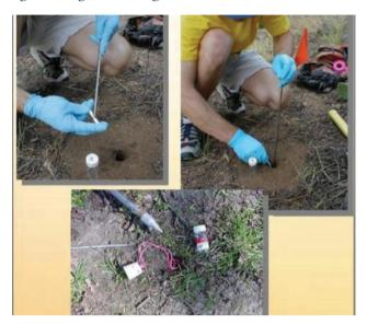
Fig. 5 - Passive soil gas samplers. Field examples of installation procedure.Fig. 5 - Campionatori passivi di soil gas. Esempio di procedura di installazione.
